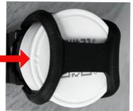
Am Fahrrad montiert zeigt die **Einkerbung** im Sensordeckel
